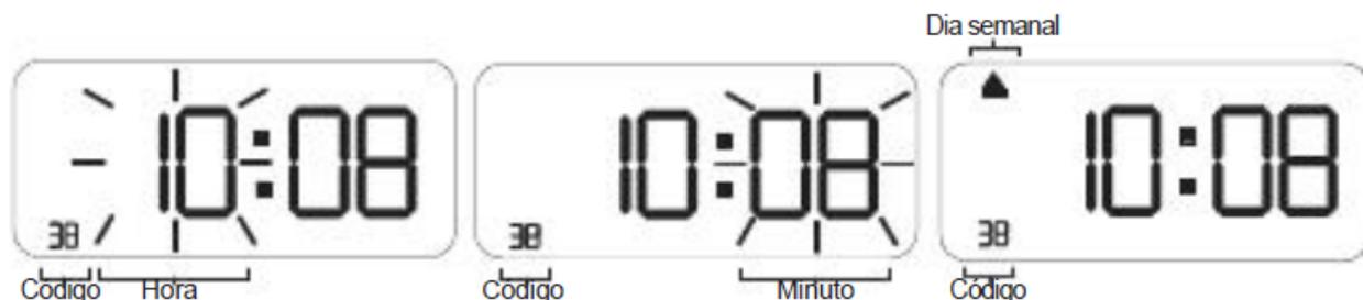
Entre na opção ‘38’ e configure os horários de entrada, de intervalo e de saída dos colaboradores. Irá piscar no visor primeiramente o campo referente à hora e após o campo referente aos minutos (esta sequência se repetirá 06 vezes –
