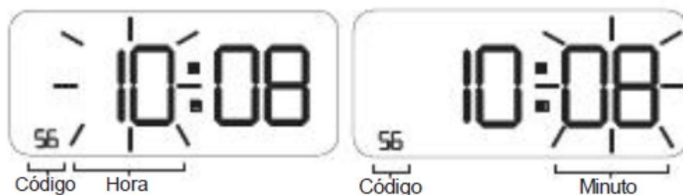
Entre na opção ‘56’ e configure os horários que deverão ser impressos em cor vermelha e/ou cor preta. Irá piscar no visor primeiramente o campo referente à hora e após o campo referente aos minutos (esta sequência se repetirá alternando as cores). Pressione ‘+’ ou ‘-’ para definir cada intervalo de horário na cor correspondente.
