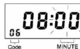
Em seguida pressione **+** ou **-** para configurar Minuto. Pressione novamente **Enter** para registrar configuração.
